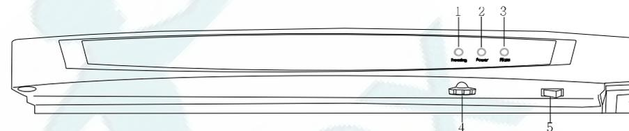
1 - жовтогаряча лампа (індикація режиму заморожування)/ оранжевая лампа (індикация режима замораживания)/ narıncı lampa (dondurulma rejimi indikasyonu)/ სტაფილოსფერი ნათურა (გაცივის რეჟიმის ინდიკაცია)/ сарғылт лампа (мұздату режимінің индикациясы)/ bec portocaliu (indica regimul de congelare)/ to'q sariq rangli lampa (muzlatish rejimining indikatsiyasi);
